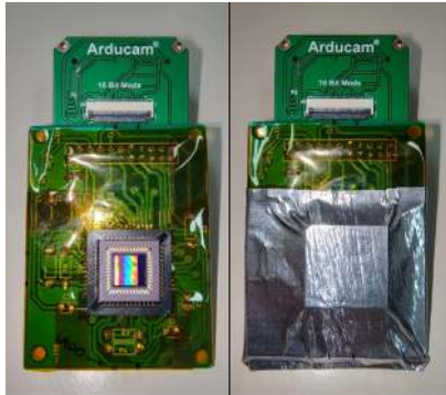
Figura 2. Fotografías de la plataforma ArduCAM UC-425, modificada para permitir la irradiación del sensor. En la imagen de la izquierda se puede observar el sensor MT9M001C12STM, mientras que en la imagen de la derecha se encuentra recubierto con una lamina de aluminio.
