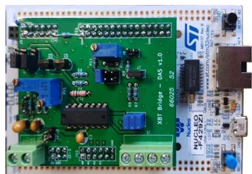
Fig. 3. Vista superior del kit NUCLEO-STM32F429ZI con la etapa de acondicionamiento encastrada en los headers de expansión.
