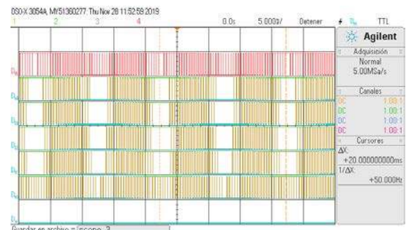
Fig. 6 Pulsos resultantes de la modulación PS-PWM
