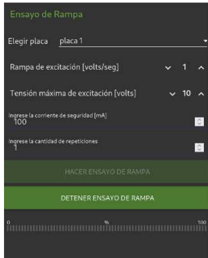
Fig. 4. Panel de control para el disparo de ensayos de rampa.
