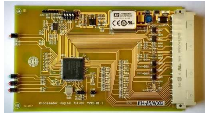
Fig. 2. Módulo de procesamiento digital basado en FPGA Spartan 6 XC6SLX9 del Sistema de Protección de Reactor de IyC-CNEA.
