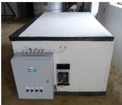
Fig. 4. Sistema Final de Refrigeración de Estado Sólido Modular.
