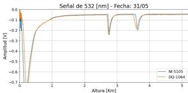
Figura 4. Señal de retrodifusión obtenida por medio del equipo.
