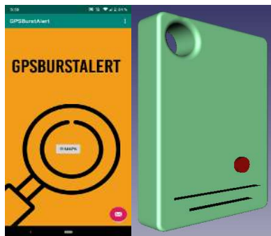
Fig. 5. Interfaz de la App y diseño 3D del gabinete del sistema.
