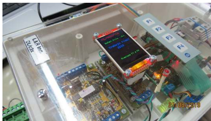
Fig. 3. Ensayo de CL3 con Display, teclado y unidad METEO.
