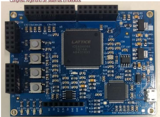
Fig. 2. Placa de circuito impreso de la EDU-CIAA-FPGA
