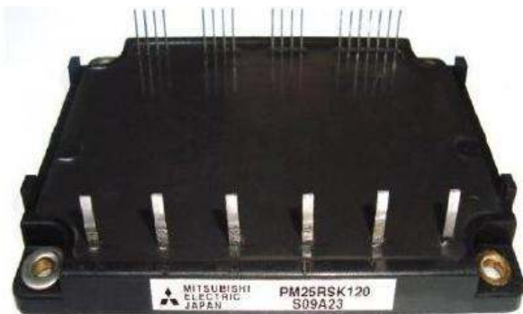
Fig. 8. Módulo: PM25RSK120, Marca: Mitsubishi.
