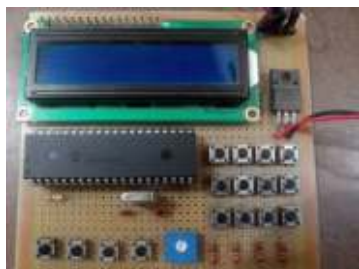
Fig. 1. Placa del generador de claves automáticas
