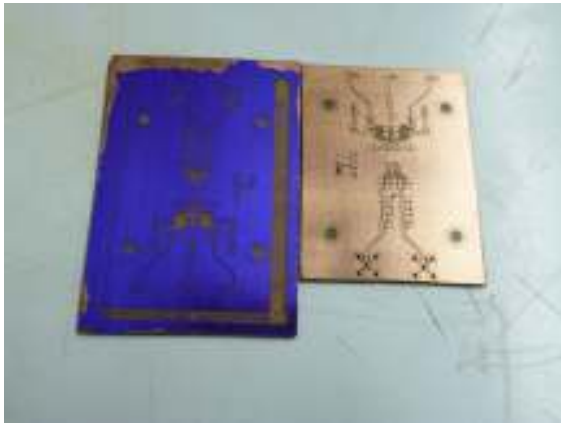
Fig. 5. En la figura se puede observar en comparación la placa finalizada a la derecha y a la izquierda la placa insolada antes de completar el proceso. Aquí se observa la definición lograda por el equipo.
