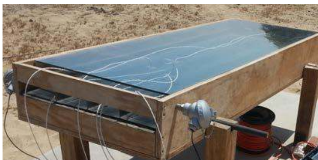
Fig. 1. Colector Solar con Sensores de Temperatura
