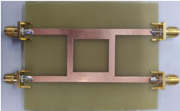
Figura 8. Acoplador Branchline construido.
