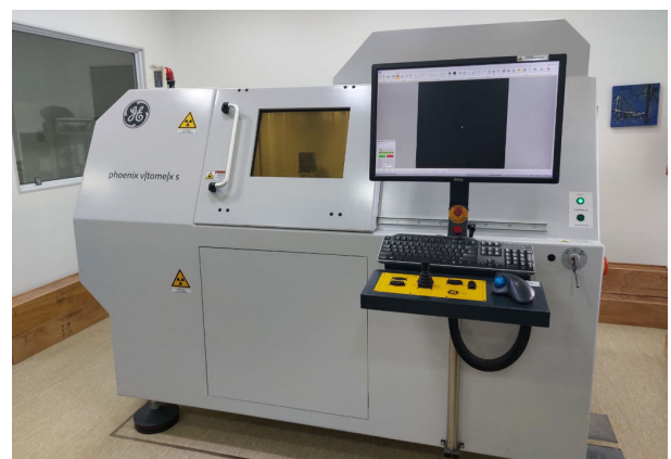
Figura 7. Tomógrafo General Electric modelo "Phoenix v|tome|x s" utilizado para la inspección por rayos X de plaquetas electrónicas.
