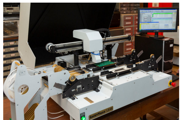
Figura 3. Equipo Pick&Place para montaje automático modelo LE40V de la firma DDM Novastar.
