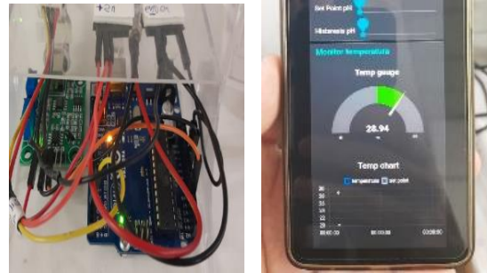
Fig. 2. (a) Arduino UNO R3 que maneja los sensores de temperatura y pH. (b). Aplicación de celular para control y seguimiento del proceso.
